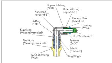
**Betriebsdruck:** max. 10 bar, sowie Grobvakuum
